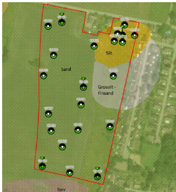
Geotekniska undersökningspunkter med grön-svarta symboler
