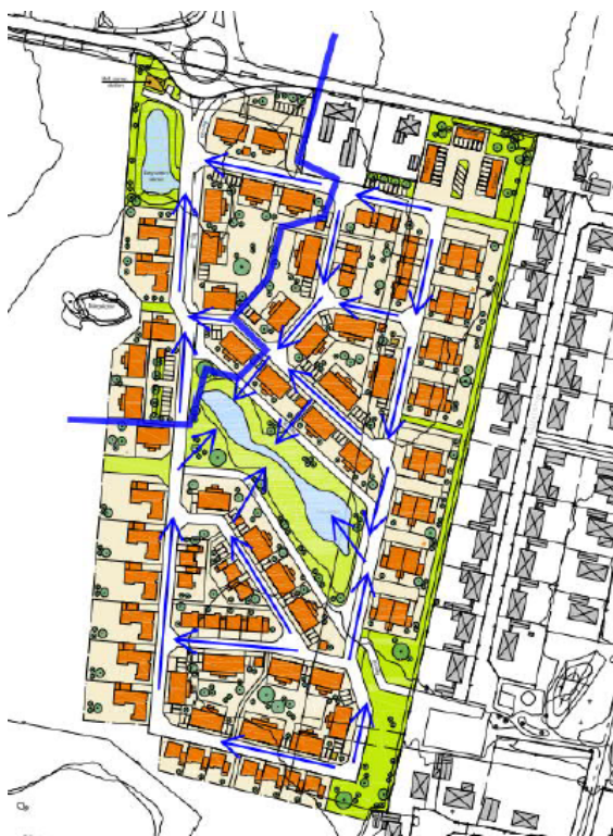
Riktning avripping för dagvatten markerat med blå pilar och gräns mellan avrinningsområde för de två dammarna markerat med blått
